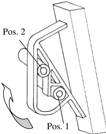
**Klappen Sie die Räder in Position 2 nach oben.** Die Räder sind zum Verschieben der Kreissäge vorgesehen. Im Betrieb muss die Säge stets auf allen vier Füßen des Gestelles stehen. Heben Sie dazu das Gestell auf der Seite der Räder hoch. Damit entlasten sie die Achse und können sie so leicht von Position 1 in Position 2 heben. Senken Sie dann das Gestell, damit die Kreissäge auf allen 4 Füßen steht.
