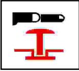
**Betätigen Sie in Gefahrensituationen unverzüglich den roten Not/Aus Schalter.** Dieser stoppt den Motor und bleibt in gedrückter Position bis Sie ihn durch Drehen wieder entriegeln.
