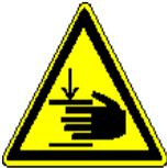
**Drücken Sie den Fußbügel durch, wenn sie mit Körperteilen zwischen das Spaltmesser und Holz oder Spalttisch und Holz geraten.** Der Zylinder fährt dann unverzüglich nach oben.
