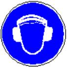
**Benutzen Sie einen Gehörschutz.** Durch das drehende Sägeblatt entstehen Geräusche mit hohen Frequenzen. Sie können zu Ohrensausen und längerfristig zu Hörschäden führen.
