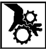
**Verhindern Sie jeglichen Kontakt mit drehenden Teilen und benutzen Sie eng anliegende Kleider. Legen Sie Schmuckstücke (Ketten) ab.** Diese könnten an drehende Teile geraten und Sie einziehen.
